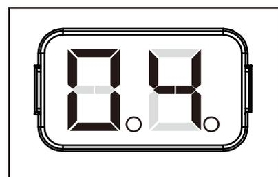
"0.4" : Durante el proceso de aprendizaje de sistema, PCB se detecta el consumo de corriente de motor automáticamente indicando el nivel de resistencia de la puerta mientras que el funcionamiento del motor. Si esta lectura aumenta al instante o mantenerse en lectura alta, compruebe si cualquier objeto existe en la zona de movimiento puerta, y ponerse en contacto con su instalador para su inspección.
